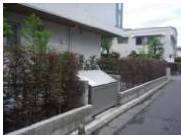
外構の植栽と組み合わせることにより目立たない工夫がされているごみ置き場の例
