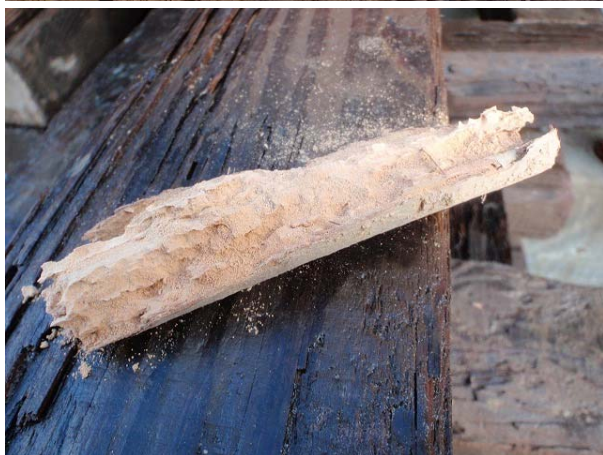
上：崩壊した北面 下：小舞に使用されていた木材
